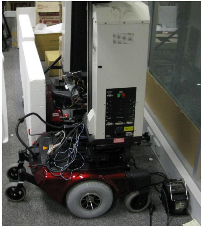
Kuva 11. Monash IRRC:ssä kehitetty robotti, joka käyttää alustanaan sähköpyörätuolia
